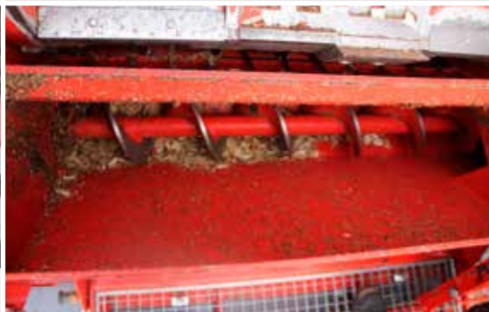
Des vis permettent de transférer la matière broyée vers le ventilateur.
