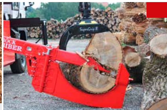
Le Spaltbiber est une pince débiteuse dont la plus grosse permet de couper en deux un tronc de 110 cm.
