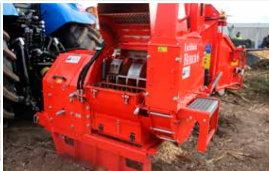
Le principe de construction du Biber 6 est identique à celui des grandes machines: un tambour hacheur suivi d'un ventilateur placé latéralement. Le principe des couteaux est le même, mais dans une version plus petite.
