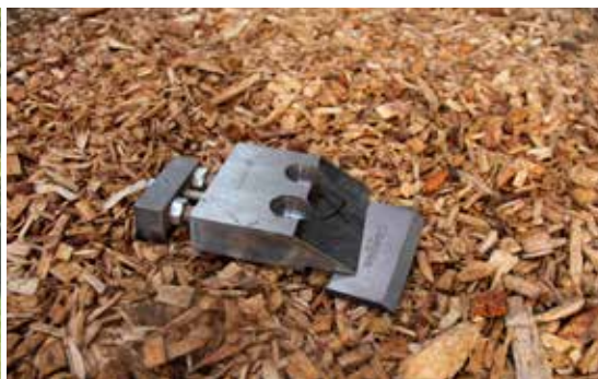
Les couteaux du Biber 78 se remplacent et se règlent simplement. Le tambour hacheur peut recevoir 6 ou 12 couteaux.
