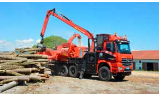
Le Turox est un broyeur monté sur un camion Mercedes 8x8 et qui permet de broyer des troncs d'un diamètre maximal de 75 cm. L'entraînement est assuré par un moteur Mercedes de 630 ch.
