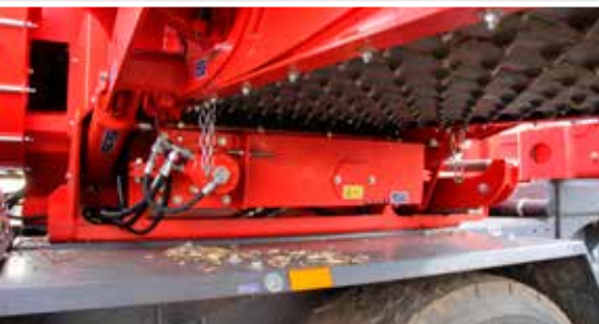
Une table à rouleaux entraînée hydrauliquement transporte les copeaux qui tombent entre les rouleaux afin de les ramener dans le flux de matière.
